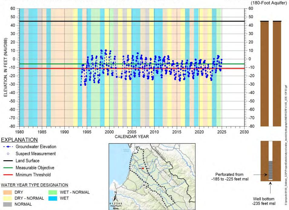
HYDROGRAPH OF MEASURED GROUNDWATER ELEVATION FOR 14S/02E-13F03
